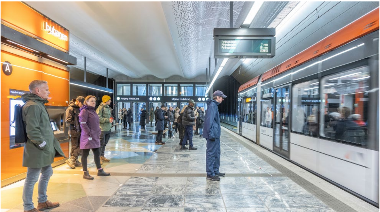
GODE LEDELINJER: På Haukeland sykehus holdeplass har ledelinjene en ru overflate, mens gulvhellene rundt er helt slette. – Det gjør dem enda mer taktile, og taktilitet er like viktig som kontrast, påpeker Øyvind Karlsen. →
