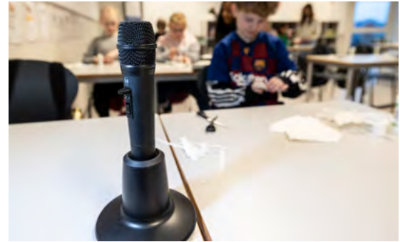
ALLE SKAL HØRE: Lærer Evy Eriksen har hodemikrofon og elevene har mikrofoner på pulten, som kan kobles til høreapparater eller høyttalere.
